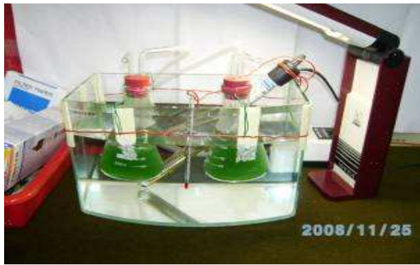
改用 4.5W 雙孔打氣機，並將培養液加至 200 cc。藻種因稀釋而顏色變淡。
