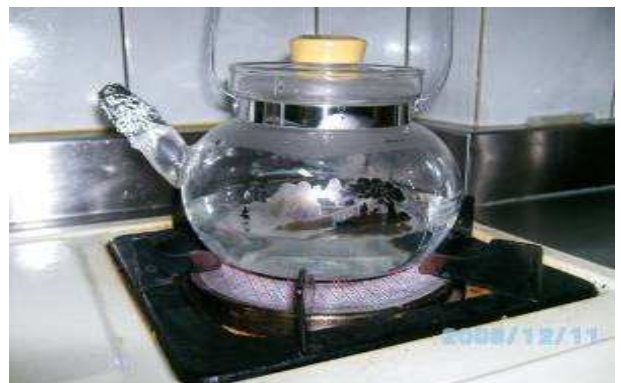
培養液煮沸殺菌，蓋上蓋子並且將水壺出水口以鋁箔紙封住，防止污染。
